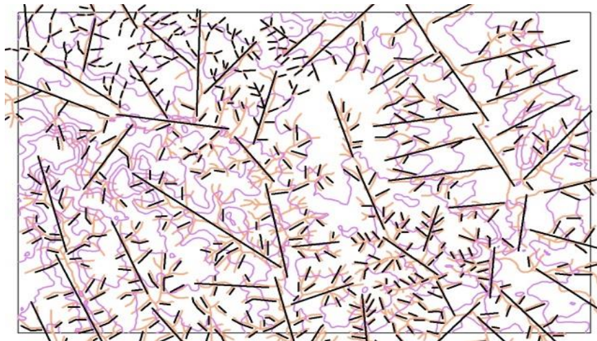
Figura 5: Rede de drenagem (lilás), lineamentos de drenagem (preto) e curvas de nível de 20 m de intervalo (laranja), caracterizando uma drenagem dendrítica.
