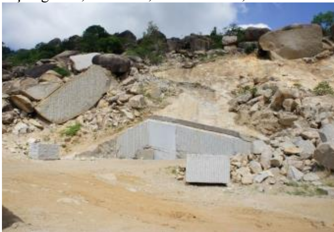
Figura 22 – Vista panorâmica da frente de desmonte dos blocos do granito Meruoca. Imagem Fernando Pina.
